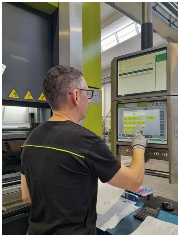
La nuova pressa piegatrice idraulica SafanDarley da 230 tonnellate con controllo touch screen facile e intuitivo
