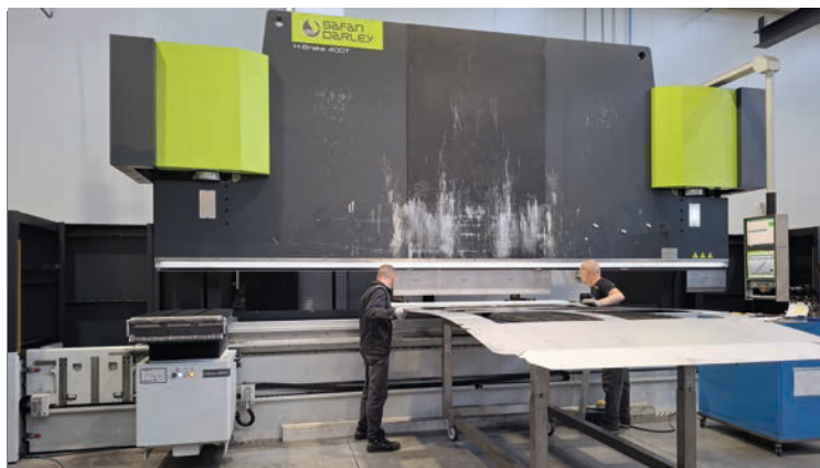
Eurosteel è specializzata nella piegatura di lamiere di grandi dimensioni in ferro, acciaio inox e alluminio
