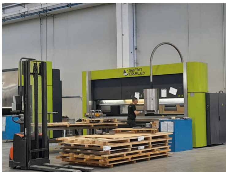
La pressa piegatrice elettrica SafanDarley presso lo stabilimento Eurosteel a Cimadolmo (TV)
