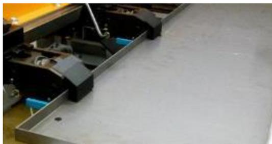
la forza di bloccaggio delle pinze è regolabile (forza max. 15 KN ciascuna) in funzione del materiale e spessore da lavorare. Possono bloccare lamiera con bordi già piegati fino ad una altezza massima di 22 mm.
