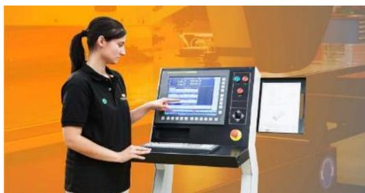
il PC FANUC alloggiato nella consolle è dotato di un ampio monitor da 15" con sistema touch-screen per agevolare l'interazione dell'operatore con la macchina.
