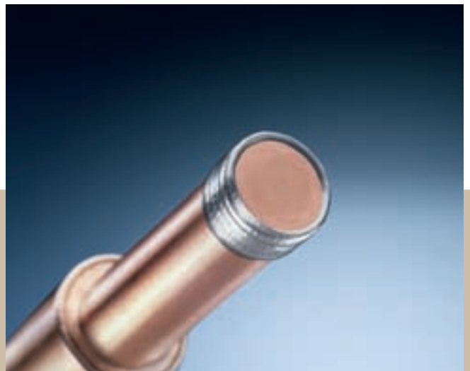
Saldatura laser con apporto su berillio-rame.
