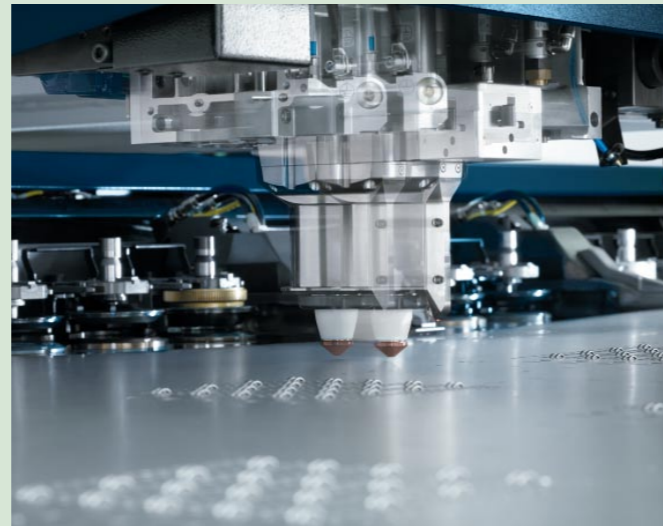
Grazie agli assi supplementari è possibile muovere il laser in due direzioni.
