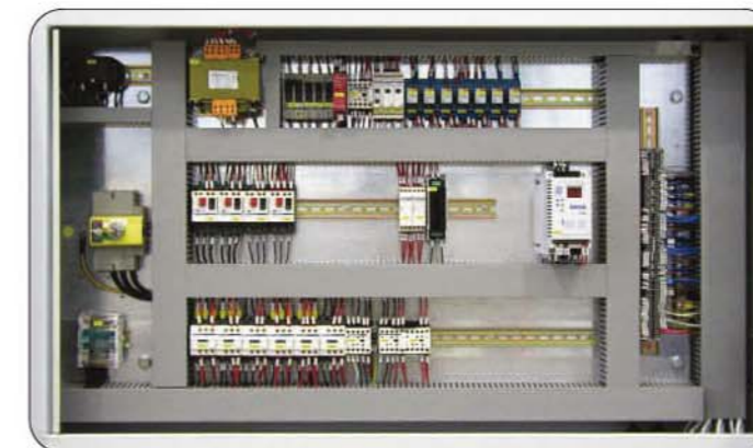
Impianto elettrico a norme CE con componenti di alta qualità di primarie marche, cablaggi numerati, schemi generali su manuali istruzione.
