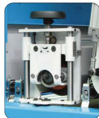
Gruppo spazzola longitudinale Ø 180 mm con regolazione manuale e visualizzatore meccanico di quota. Sistema di oscillazione laterale. Sono disponibili spazzole in acciaio, acciaio inox, scotch brite, tynex e lamellari.
