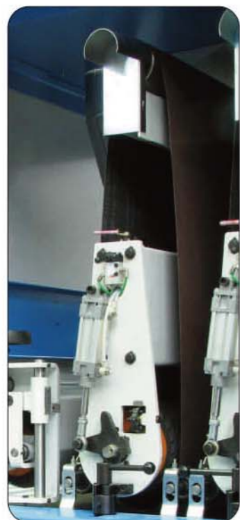
Gruppo cilindro con Grit-Set pneumatico a 6 posizioni per compensare le variazioni di spessore delle varie grane abrasive
