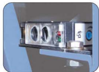
Oscillazione nastri con fotocellula
