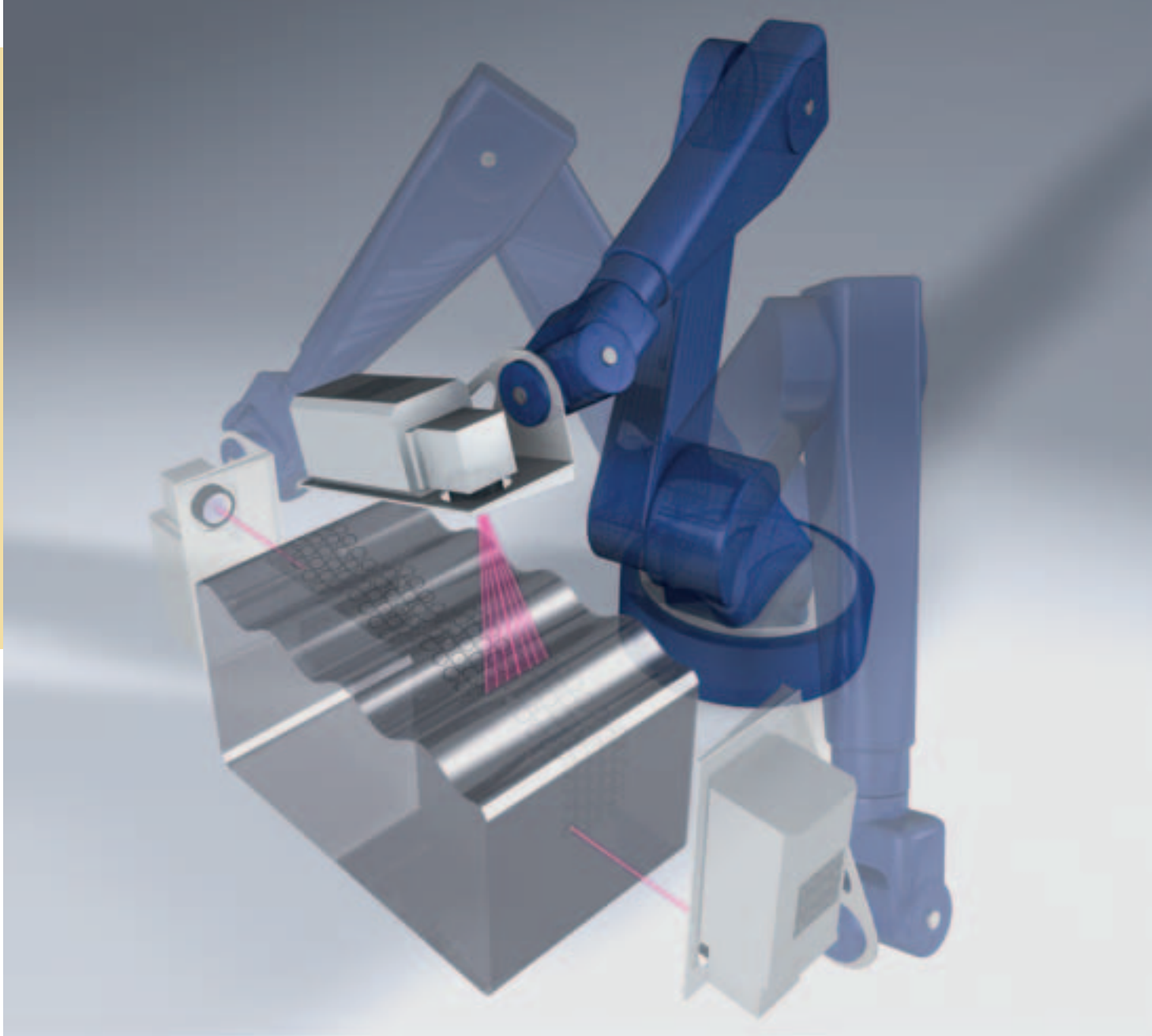
La marcatura laser avviene grazie alla sovrapposizione del programma di marcatura e il movimento robotico.
